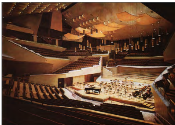
Abb. 21: Innenansicht der 1963 in Berlin eröffneten Philharmonie mit den von Lothar Cremer eingeführten Weinbergblöcken
