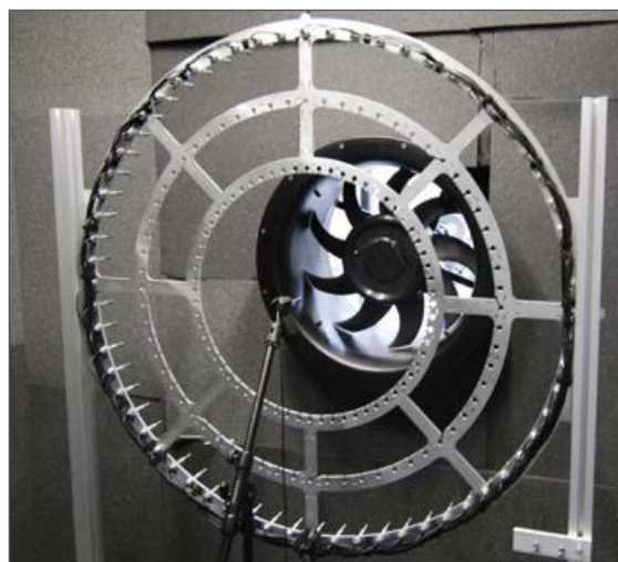
Abb. 1: Messaufbau eines Axialventilators mit dem Mikrofonarray auf der Saugseite [7] (Ventilatorprüfstand, FAU Erlangen-Nürnberg).
