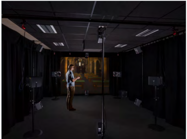
Abb. 6: Versuchsperson mit 3D-Brille in einem HOA-Lautsprecherarray.
