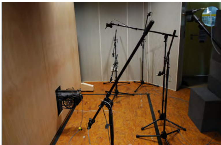
Abb. 9: Prüfstand zur Luft- und Körperschallmessung von separierten E-Bike-Antrieben.
