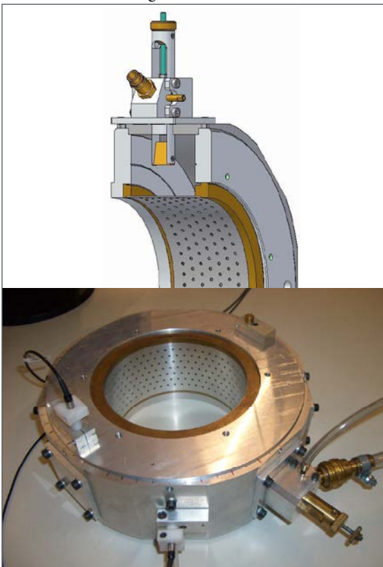
Abb. 5: Skizze (oben) und Foto (unten) des im annularen Linervolumen eingesetzten Aktuators
