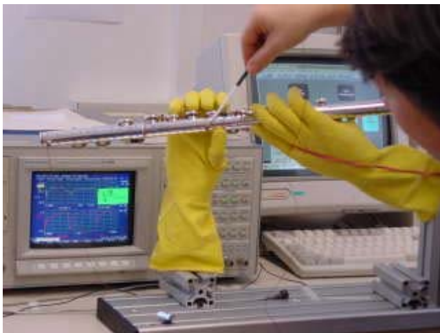
Abbildung 4: Modalanalyse an einer Flöte in Spielhaltung
