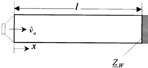
Abbildung 5-3: Charakteristische Größen für die Schallausbreitung in Rohren
