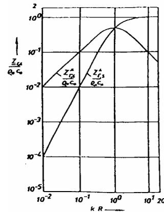
Abbildung 3-1: Spezifische Strahlungsimpedanz an der Oberfläche eines Kugelstrahlers
