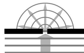
Abbildung 4-6: Schallausbreitung am Spalt (tiefe Frequenzen)
