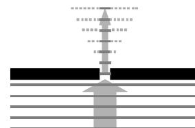
Abbildung 4-5: Schallausbreitung am Spalt (hohe Frequenzen)
