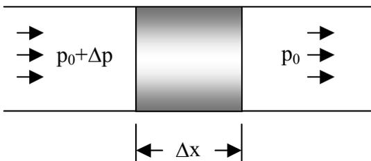
Abbildung 5-2: Druckdifferenz  $\Delta p_0$  zwischen Vorder- und Rückseite eines Prüfstücks der Dicke  $\Delta x$
