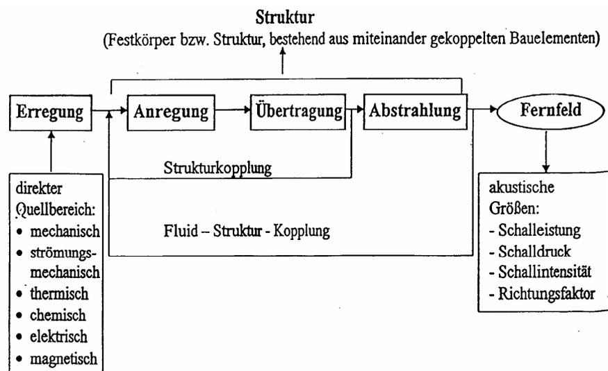
Abbildung A4-2: Mechanismen der indirekten Geräusentstehung
