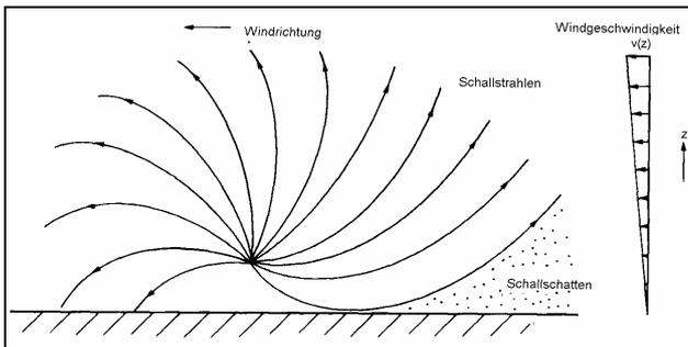
Abbildung 6-6: Krümmung der Schallstrahlen infolge des Windgeschwindigkeitsgradienten, vgl. [32].
