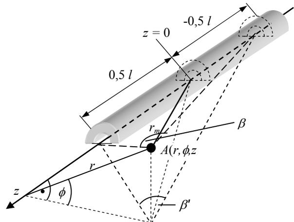
Abbildung 6-2: Koordinaten zur Bestimmung des Schallquellenform - Korrekturmaßes
