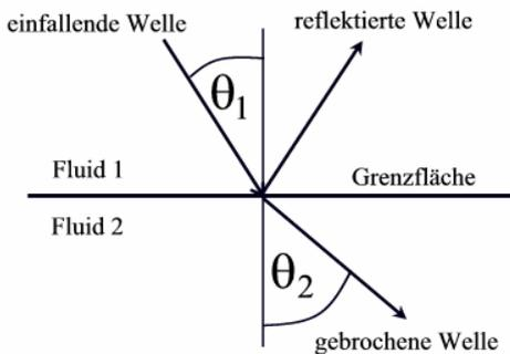
Abbildung 4-2: Brechung von Schallwellen an der Grenzfläche zweier Fluide (Refraktion), Bsp.:  $c_2 > c_1$
