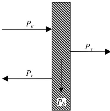
Abbildung 4-1: Leistungsbilanz für Schallwellen an einer Trennfläche
