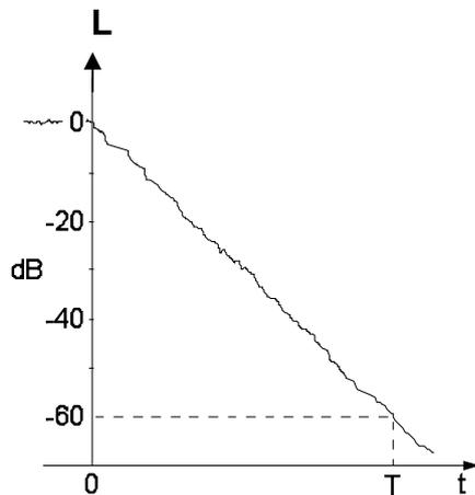
Abbildung 5-1: Schematischer Pegel-Zeit-Verlauf zur Bestimmung der Nachhallzeit
