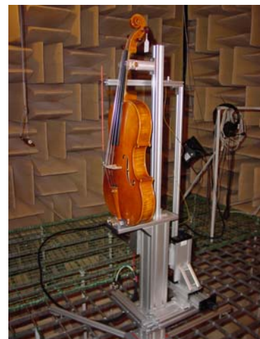
Abbildung 4: Einspann- und Anregevorrichtung zur Frequenzkurvenmessung an Geigen und Bratschen
