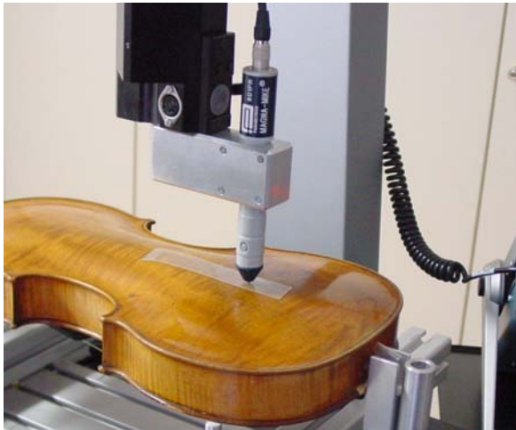
Abbildung 2: Dickenmessung an einer Geige
