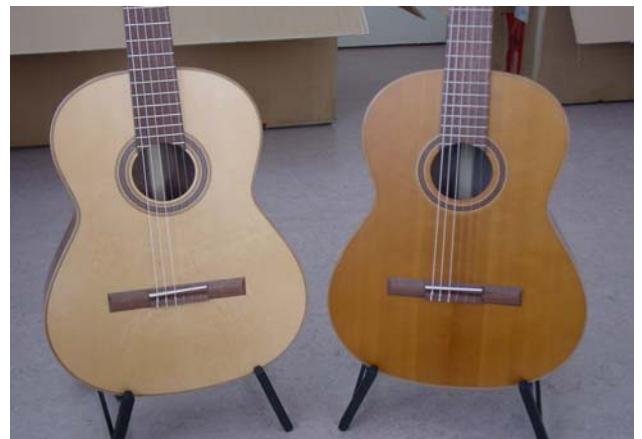
Abbildung 2: Vergleich Gitarre unbehandelt (links), mit Thermoholzdecke (rechts)
