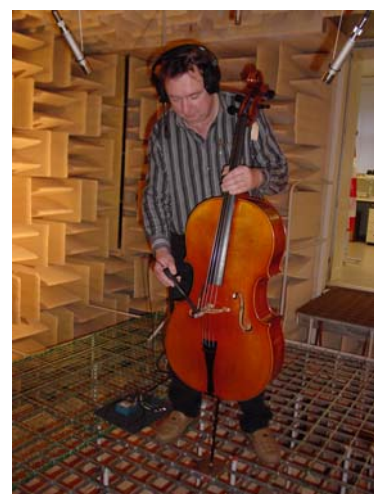
Abbildung 5: Frequenzkurvenmessung an Cello
