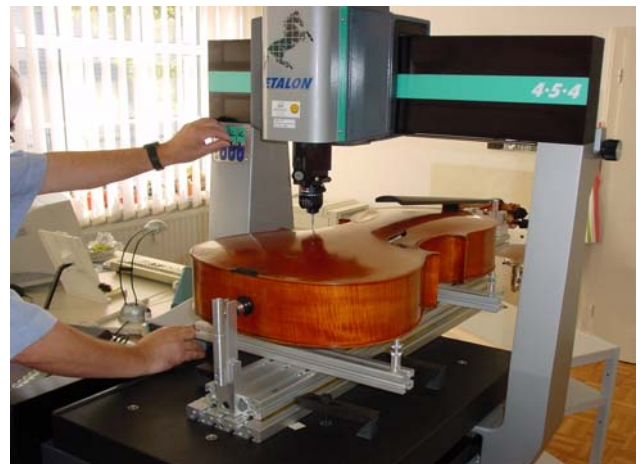
Abbildung 1: Cello auf Koordinatenmessmaschine
